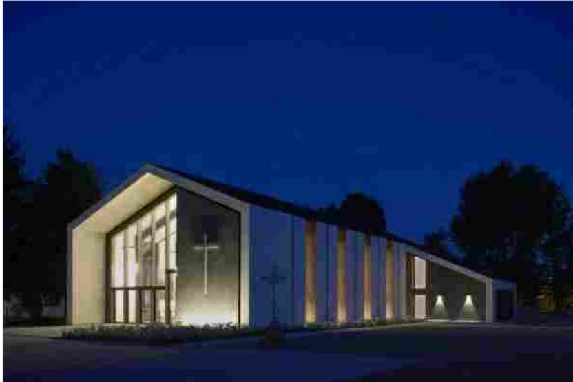
Luce e trasparenza sono garantite dalle **vetrate**, a tutt'altezza, presenti sulla facciata principale e sulle laterali. Un ampio porticato e la profondità degli imbotti (1 m) nella scansione dei fianchi garantiscono l'ombreggiamento: una buona protezione dall'irraggiamento solare nelle ore centrali della giornata, mentre l'altezza delle aperture assicura un'efficace illuminazione in profondità sino alla parte centrale della navata.
